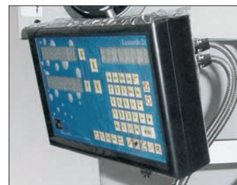
Cod. 40025: Visualizzatore di quote 2 assi.
