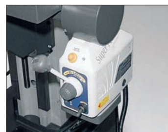
Cod. 40026 Power: Avanzamento automatico longitudinale meccanico della tavola.
